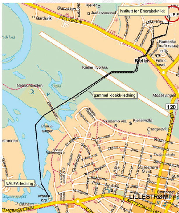
Figur 1. Utslipp via lokal kloakkledning til Sogna (stiplet linje) og den nye NALFA-ledningen som ble brukt etter 1967 (heltrukket linje)
