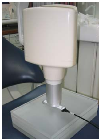
Måleteknisk kontroll av dentalt røntgenapparat og vurdering av bildekvalitet vha. et bildekvalitetsfantom. (Foto: Statens strålevern)
