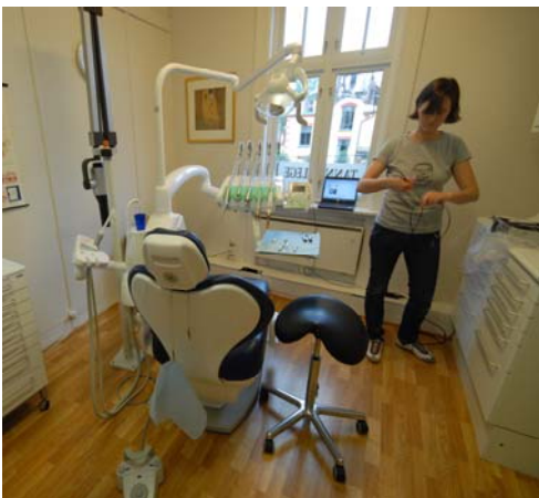
Måleteknisk kontroll av dentalt røntgenapparat og vurdering av bildekvalitet vha. et bildekvalitetsfantom. (Foto: Statens strålevern)
