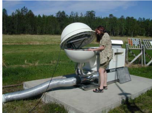
Замен фильтров на контрольно-измерительной станции Сванховда.
