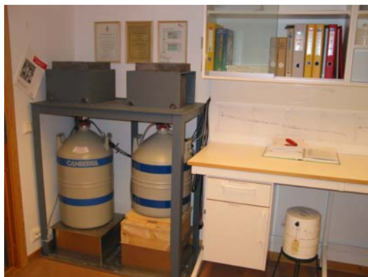
Контроль-измерительная лаборатория группы Сванховд, располагающая двумя детекторами гамма-излучения.
