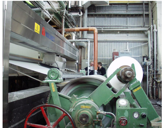
Kilden sitter i skanneren som kontinuerlig sjekker tettheten på det produserte papiret
