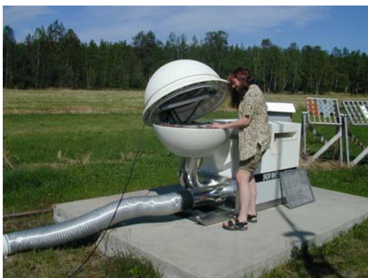
Filterskifte på Beredskapsenhetens luftsuger på Svanhovd. Foto: Statens strålevern
