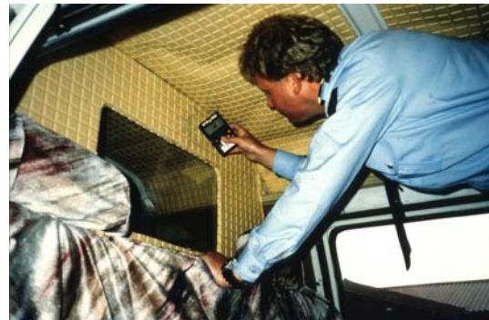
Grensekontroll ved Storskog med måleinstrumentet "Automess". Foto: Storskog grensestasjon
