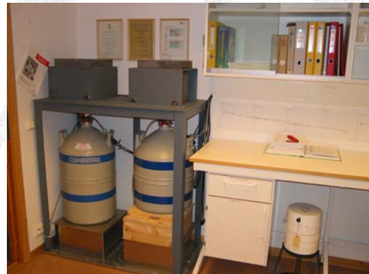
Beredskapsenhetens målelaboratorium med to gammadetektorer. Foto: Statens strålevern
