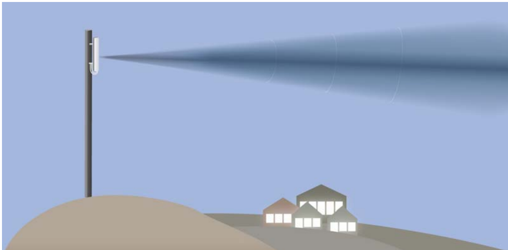
Illustrasjon av hvordan en basestasjon sender. Det er i dette området eksponering vil være størst. Illustrasjon: Strålevernet.
