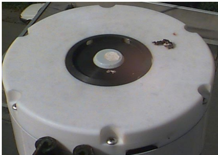
Figur 1. GUV 541 på taket på Østerås. Fugleskitt på diffusoren viser hvor viktig det er å rengjøre instrumentene regelmessig.
