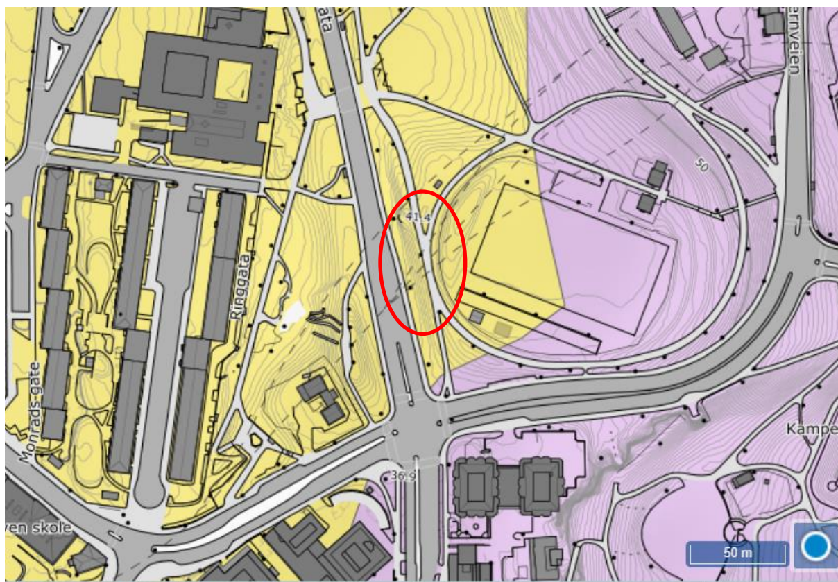
Figur 7. Løsmassekart over Tøyen. De stiplede grå linjene er t-bane tunnelene. Gul farge viser elve- og bekkeavsetning. Lilla farge viser forvittringsmateriale (kart fra NGU). Omtrentlig plassering av tiltaksområde vist med rød sirkel.
