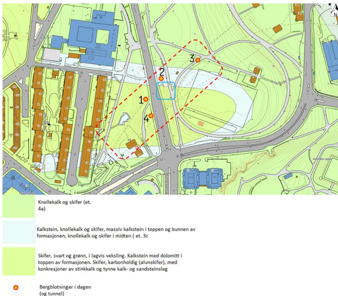
Figur 2: Berggrunnskart over Tøyen, NGU. Rødt omriss viser Tøyen T-banestasjon og blått omriss viser plasseringen til sjakta. De stiplede grå linjene er t-bane tunnelene. Kjerneprøvene er tatt innenfor blått omriss.
