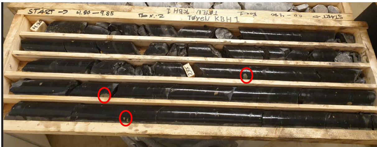
Figur 5. Kjernebasse 2; 4,8 – 9,85 meter. Røde sirkler viser sulfidkrystaller.
