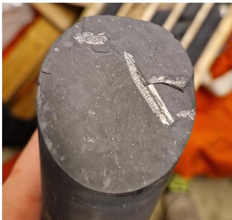
Figur 9: Fossiler (graptolitt) på sprekkplan som er særegent for galgebergskiferen.
