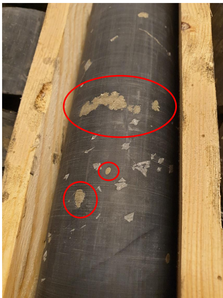
Figur 7. Nærbilde av kjerne som viser sulfidkrytaller (røde sirkler).
