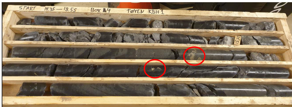
Figur 6. Kjernekasse 4; 14,35 – 18,55 m. Røde sirkler viser sulfidkrytaller.
