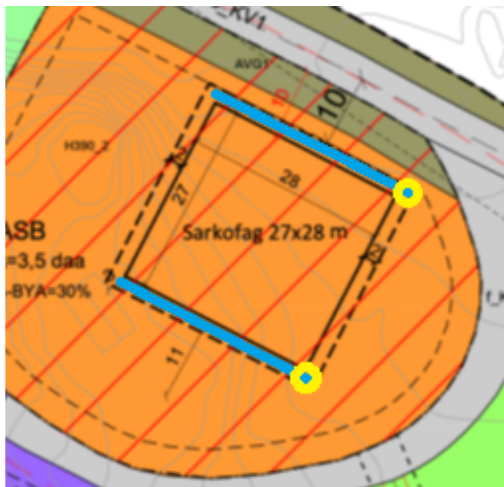
Figur 67 Foreslått overvåkningsløsning for sarkofagen der rør på nordsiden og sørsiden av sarkofagen mater hver sin oppsamlingskum. (Norconsult/Bergfald Miljørådgivere)
