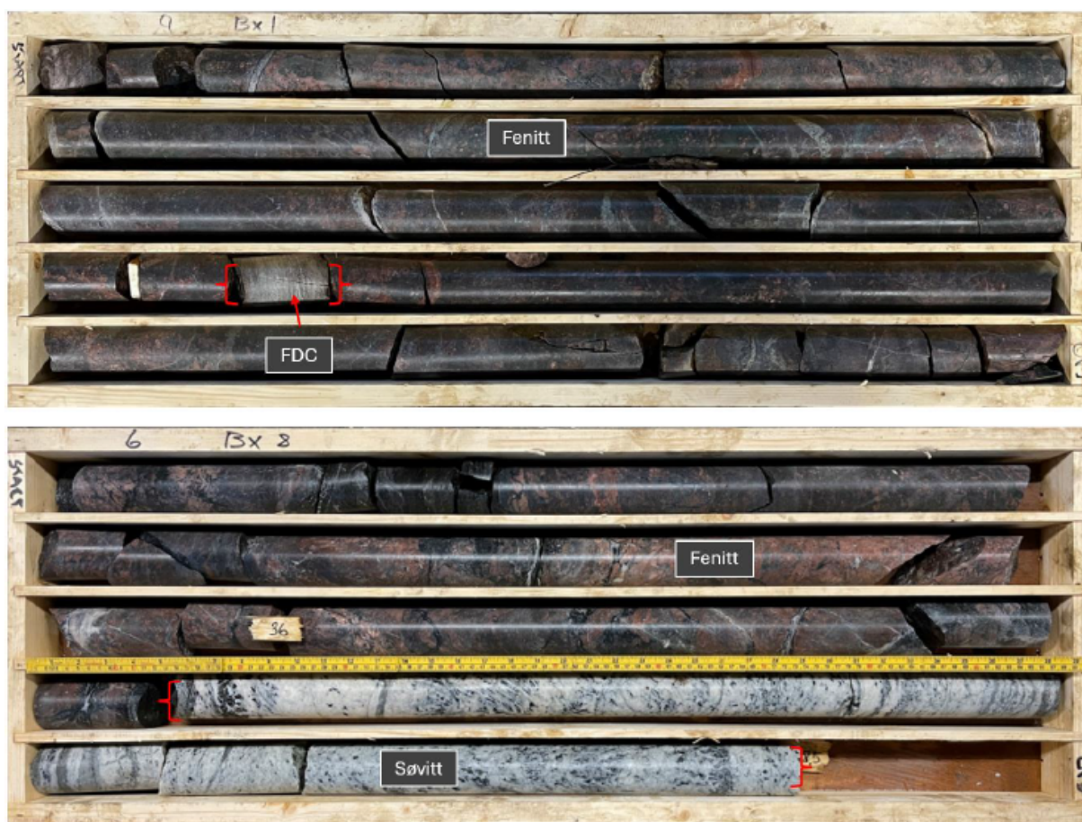
Figur 17 Øverste kasse viser de øverste 5 meterne fra kjerneprøve fra punkt NO_6, nederste kasse viser nederste 5 meterne fra samme prøve. (Sven Dahlgren)
