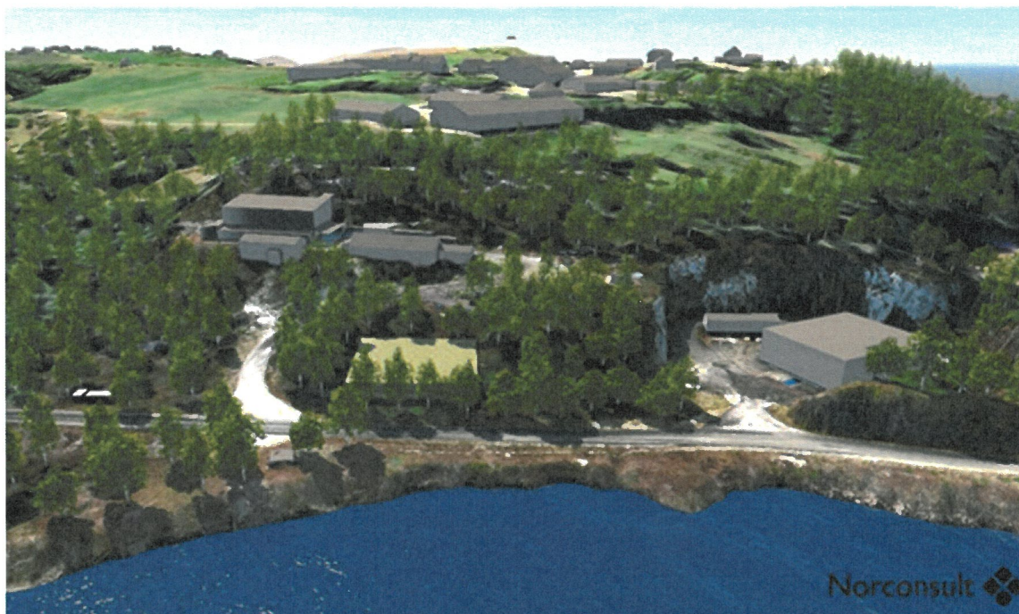
Figur a) Oversikt over hvordan sarkofagen (lysegrønn boks nærme veien) og området rundt er planlagt å se ut etter at tiltaket er gjennomført.
