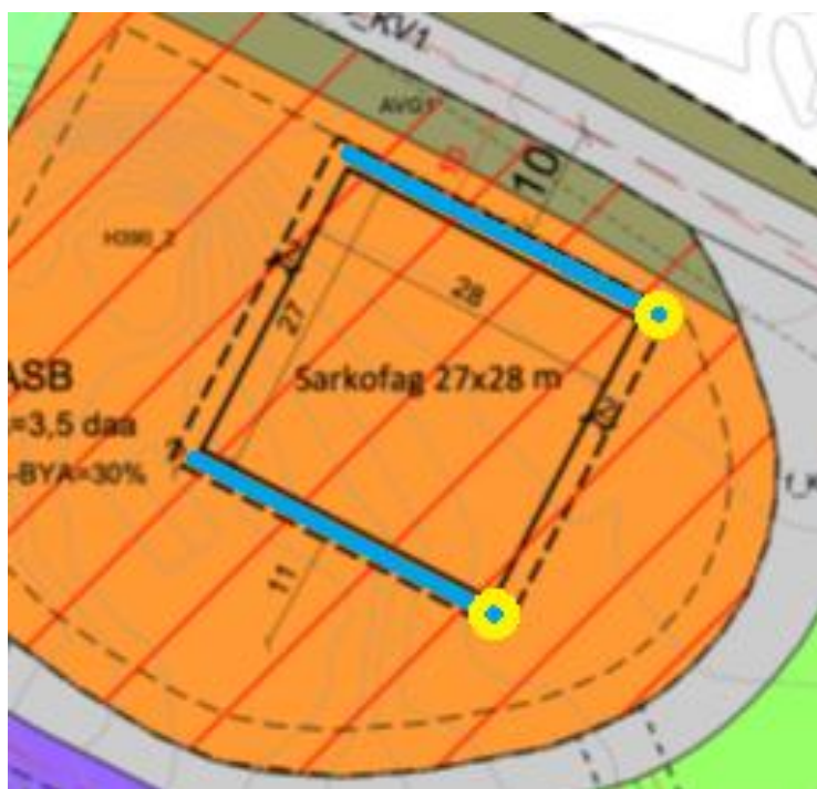
Figur 1 Foreslått overvåkningsløsning for sarkofagen der rør på nordsiden og sørsiden av sarkofagen mater hver sin oppsamlingskum. (Norconsult/Bergfald Miljørådgivere)
