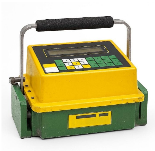
Figur 24 Eksempel på en bærbar asfaltmåler (foto: DSA - bildet er modifisert for å sladde informasjon).
