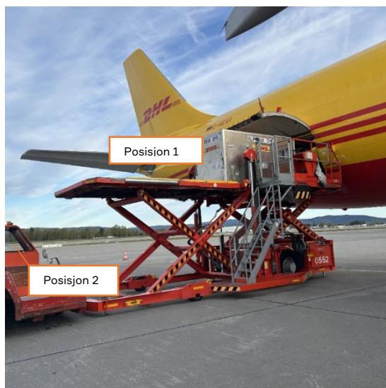
Figur 40 Lossing av en Unit Load Device (ULD), som inneholder kolli med radioaktive legemidler, fra flyet.
