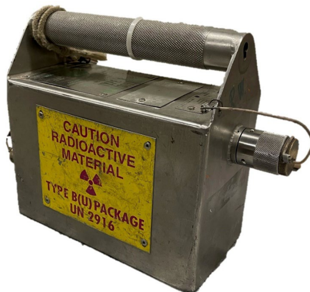
Figur 20 Eksempel på en eldre kombinert skjermings- og transportbeholder for industriell radiografi (foto: DSA).
