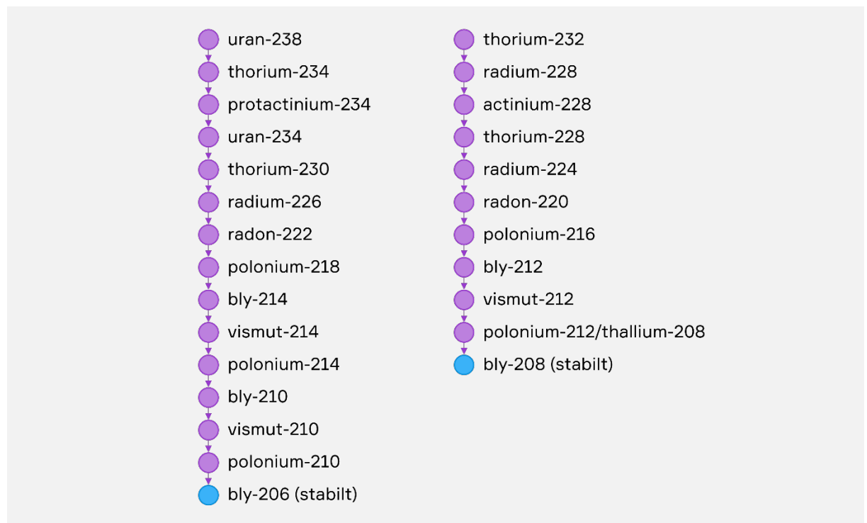
Figur 1. Oversikt over alle stoffene i de to nedbrytningsseriene som har størst betydning for stråledoser i dag: uran-238- og thorium-232-seriene.
