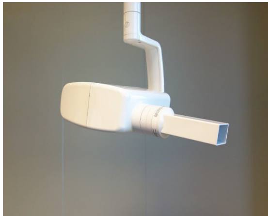
Figur 3.1 Røntgenapparat med rektangulær tubus. Foto: Universitetet i Oslo.
